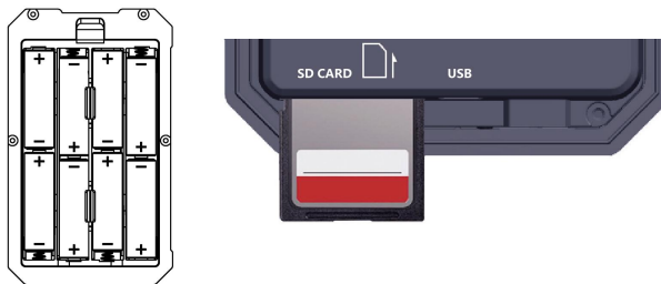
Figura 5: Instalación de baterías y tarjeta SD
